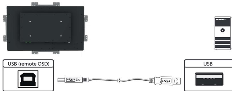
Anschließen des Touch an einen PC mit USB Kabel (nur bei Touchmonitoren)
