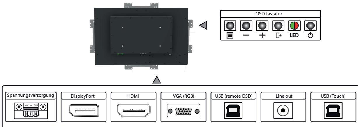
Anschließen an einen PC mit VGA Kabel
