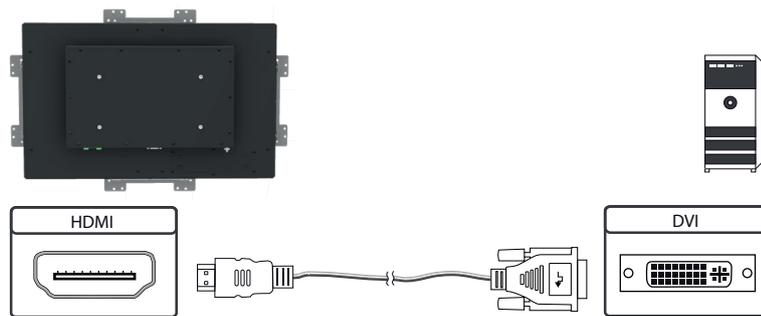
Anschließen an einen PC oder ein externes Gerät mit HDMI Kabel
