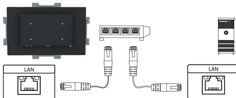
Anschließen an einen PC mit Cross-Over Netzwerkkabel
