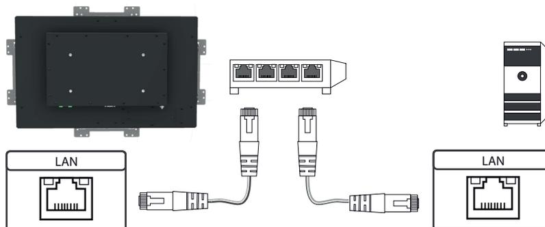
Anschließen an einen PC mit Cross-Over Netzwerkkabel
